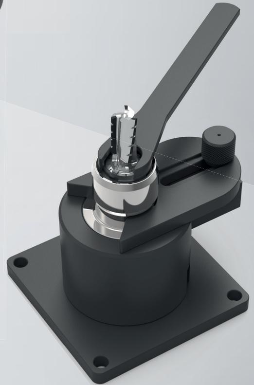
Die modulare Montagevorrichtung von T-Tool bietet Ihnen die Möglichkeit verschiedene Werkzeugaufnahmen an einer Montagestation **fachgerecht und sicher zu montieren**. Die Werkzeugaufnahme wird bei diesem Halter komplett autark fixiert. Somit haben Sie beim eigentlichen Spannvorgang beide Hände zur Bedienung des zu spannenden Werkzeuges frei.
